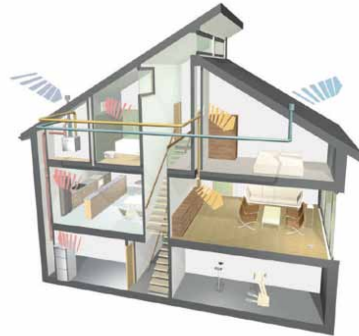
Lüftungsanlage mit Wärmerückgewinnung. Aus Küche, Bad und WC wird Abluft abgesaugt und ihre Wärme wird über einen Wärmetauscher auf die Zuluft übertragen, die in Wohn- und Schlafräume strömt.
