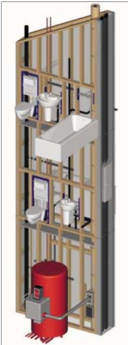
Bild 33 Vorgefertigter Installationskern mit angedockten Sanitärelementen. Der Installationskern nimmt alle Leitungen für die Versorgung und Entsorgung des Hauses auf.
