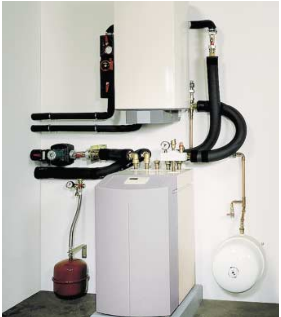
Bild 38 Kompakte Wärmepumpenanlage für Betrieb mit Erdsonden, Erdkollektoren oder Grundwasser. Der technische Speicher mit 100 l Inhalt ist über der Wärmepumpe angebracht. Für die Warmwasserbereitung ist ein zusätzlicher Speicher nötig.
