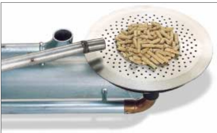
Bild 41 (oben) Brennteller eines Pelletkessels mit Heißluft-Zündstab. Die Pellets werden von unten nachgeschoben. Die Asche fällt über den Rand des Brenntellers in den Aschebehälter.
