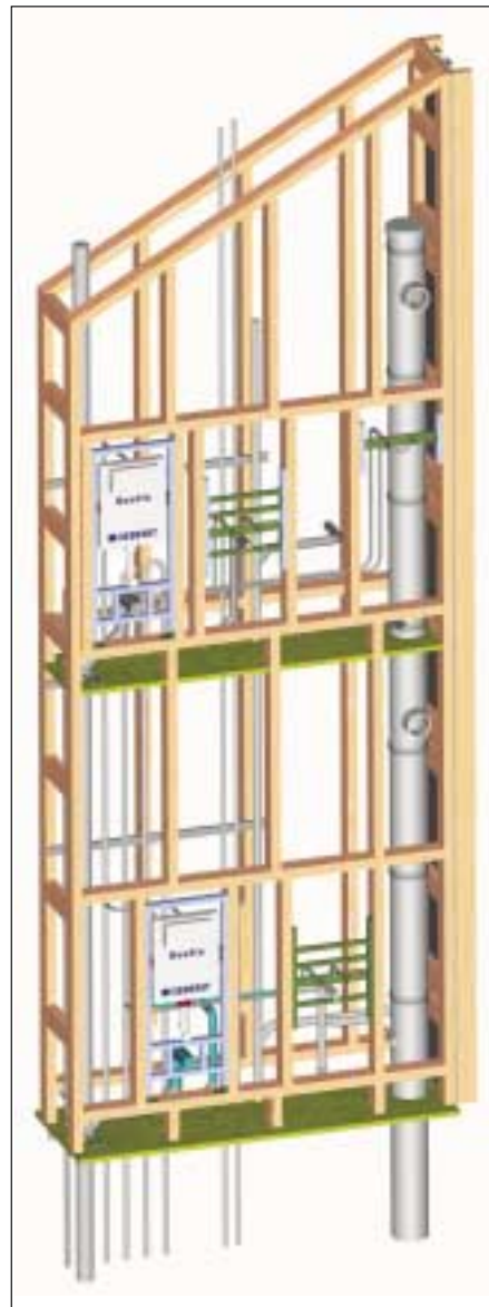
Bild 34 Blick in das Innere eines vorgefertigten Installationskernes in Holzbauweise. Rechts ist das Lüftungsrohr mit den beiden Abflutstützen zu erkennen. Das Abwasserrohr ist auf der linken Seite des Kernes eingebaut.
